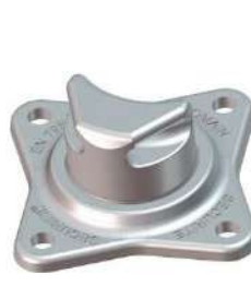
Renvoi d'angle alu orientable Tous les 15 mètres maximum 4 trous entraxe 100 mm
