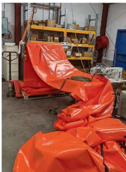
Fabrication d'un barrage de 50 mètres
