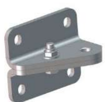
Extrémité inox, 4 trous Entraxe 100 x 80mm Fixations : M12 ou par soudure Adaptable sur une structure métallique
