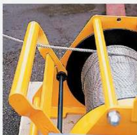
Interrupteur de mou de câble Arrête automatiquement le treuil en déroulement lorsque le câble n'est plus tendu (en descente lorsque la charge rencontre un obstacle ou en traction).
