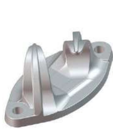
Intermédiaire alu Tous les 15 mètres maximum 2 trous entraxe 100 mm Fixations M10 ou m12
