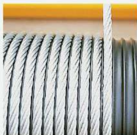
Tambour rainuré Il facilite l'enroulement correct du câble sur la première couche. Indispensable pour installer un système de va-et-vient.
