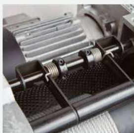
Rouleau presse-câble Permet un enroulement ordonné du câble sur le tambour. Complément indispensable du tambour rainuré sur une seule couche d'enroulement et dans le cas où le câble n'est pas tendu en permanence (enroulement à vide en traction). Déconseillé en cas d'enroulement du câble sur plusieurs couches. Obligatoire avec un système de va-et-vient.
