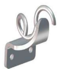
Intermédiaire inox Positionné tous les 25m 2 trous entraxe 72 mm Fixations : m12 ou par soudure Adaptable sur support métallique et support béton
