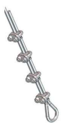
Lot de 4 serre-câbles et une cosse coeur inox Les cavaliers doivent être installés du côté du brin mort avec un écart de 8 cm environ. Sur la ligne de vie renforcée, ce système est utilisé aux 2 extrémités du câble
