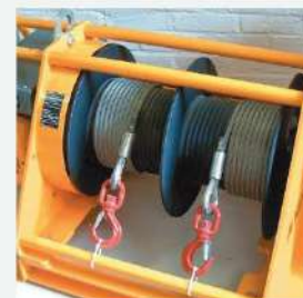
Tambour à flasque supplémentaire Permet d'enrouler plusieurs couches avec 2 câbles.
